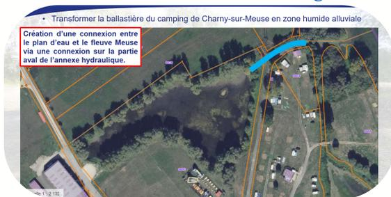
**L'idée présentée s'appuie sur le creusement d'un chenal de 75 m entre la Meuse et le plan d'eau pour permettre une circulation permanente de l'eau.**
